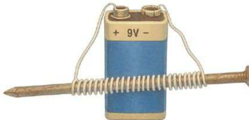
Fig. 7-P7. Electroimán casero. Al enrollar un conductor con corriente sobre un clavo de hierro, el campo magnético se refuerza.
