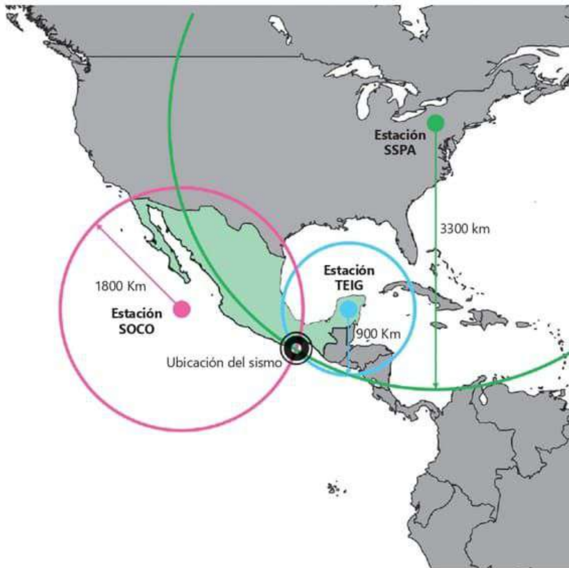
Fig. 12-P9. Cada estación define una circunferencia con radio igual a la distancia estimada por la diferencia de llegada entre ondas P y S; el cruce de ellas da una estimación del epicentro.
